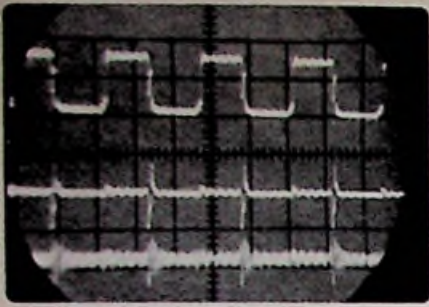
Afb. 8. Van boven naar onder: de spanningen op de punten A, B en C uit figuur 7. Schalen respectievelijk: 10, 15 en 0,5 V/verdeling.
